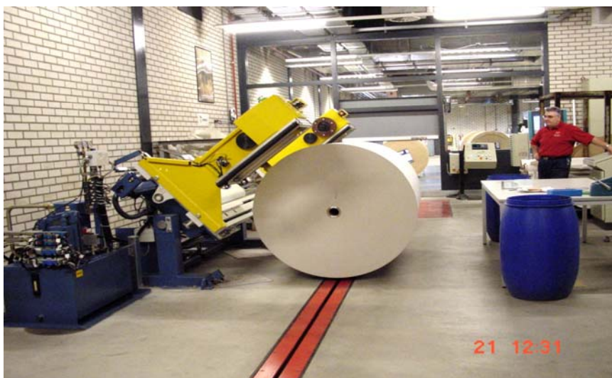
Het uitpakken van de rollen is geautomatiseerd
