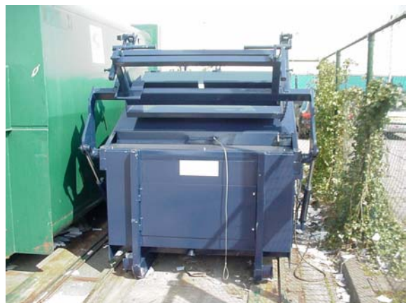
Kantelmechanisme op papierafval container
